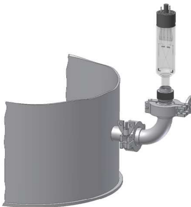
Схема подключения датчика ПМТ-2 к вакуумной системе
